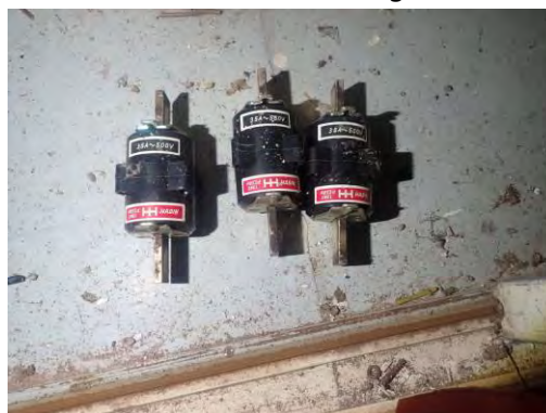
Foto 7: alle bakelieten meszekeringen tenminste als asbestverdacht beschouwen.
